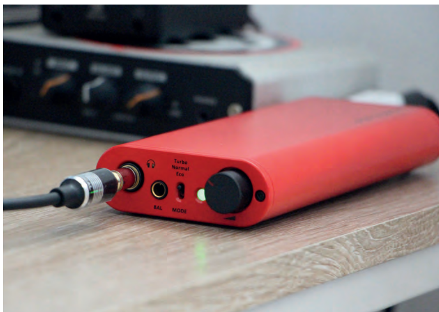
Le DAC USB iFi Audio iDSD Diablo offre une sortie casque asymétrique au format jack 6,35 mm et une sortie casque symétrique au format mini-jack 4,4 mm
