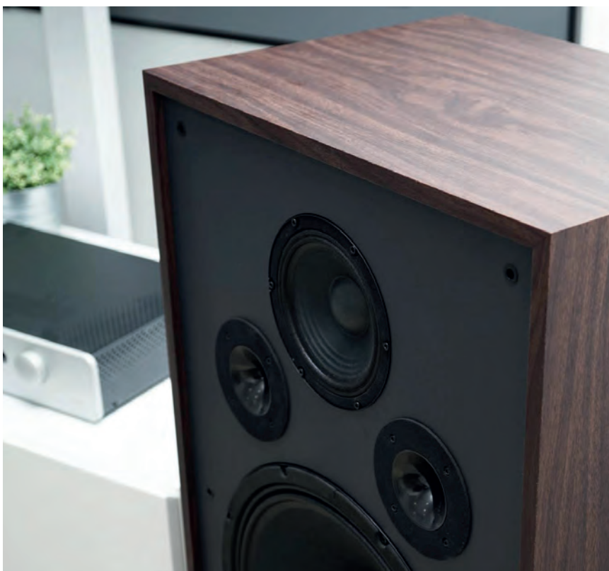
L'enceinte Eltax Monitor PWR 1959 adopte un double tweeter avec ogive centrale pour limiter la distorsion.
