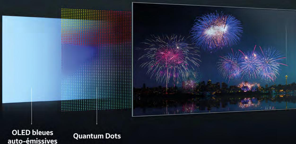
*En s'affranchissant des cristaux liquides (LCD) au profit de l'OLED, la technologie QD-Display offre un temps de réponse quasi instantané avec à la clé une réactivité optimale, très précieuse pour les jeux vidéo.*
