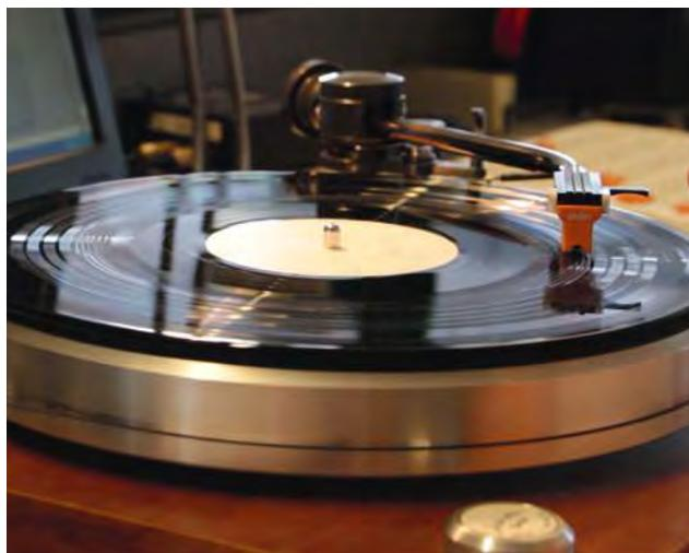
L'ENSEMBLE DES CELLULES MC SONT TESTÉES À L'AIDE D'UNE PLATINE MODIFIÉE POUR CETTE TÂCHE
