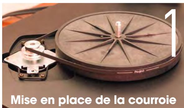
**Mise en place de la courroie**
