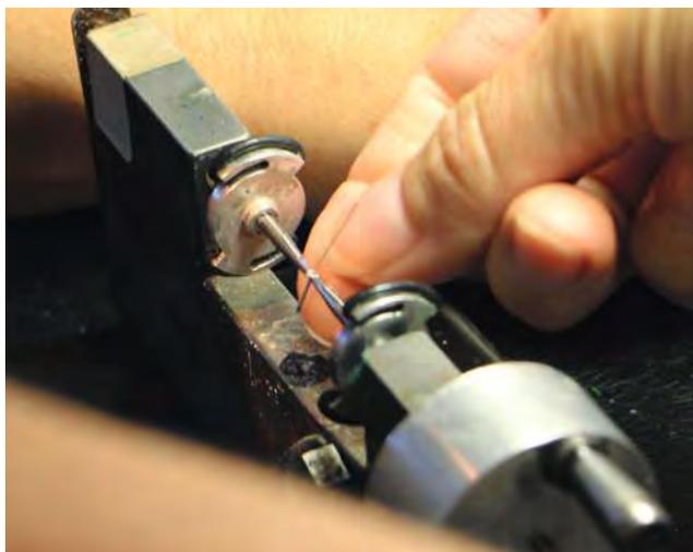
LES BOBINES DES CELLULES MC SONT ENTIÈREMENT RÉALISÉES À LA MAIN
